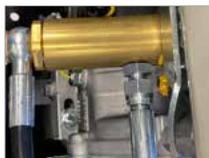
LA VERSION "GD" EST ÉQUIPÉE D'UN DÉCÉLÉRATEUR HYDRAULIQUE PERMETTANT UNE MEILLEURE LONGÉVITÉ
