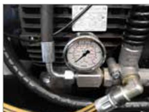
MANOMÈTRE PROFESSIONNEL PERMETTANT LE CONTRÔLE CONSTANT DE LA PRESSION DE SERVICE
